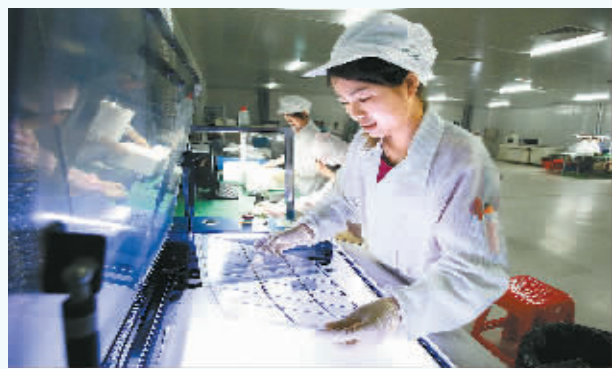
豪宇电子：豪宇电子员工正在加工手机触摸屏。豪宇电子科技有限公司为国家重点高科技扶持企业，拥有 6 条电容屏生产线和 2 条电阻屏生产线，其中电容屏生产线配有黄光蚀刻线和激光蚀刻线，能完成触控行业 OGS 等复杂和精密工艺类的触摸屏生产。 商丘日报记者 崔申义 摄
