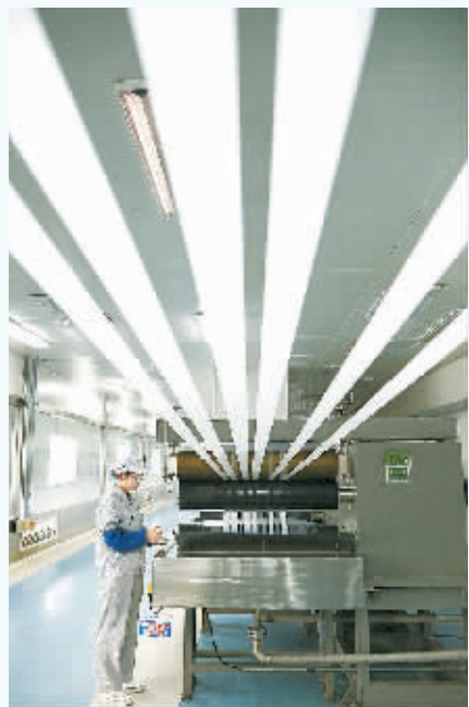
永煤碳纤维：永煤碳纤维有限公司员工在车间内忙碌着。该项目是河南能源化工集团有限公司与中国科学院山西煤炭化学研究所战略合作建设的碳纤维新材料高新技术企业，其年产 500 吨的 T300 级碳纤维产品成功应用于航天领域。
