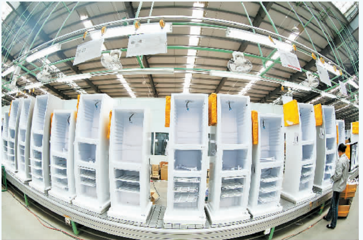
工人们在冰箱生产线上忙碌。广州万宝集团在民权投资兴建的制冷工业园项目总投资20亿元，具备年产冰箱、冷柜300万台、制冷压缩机600万台、冷藏车专用机组2万台的生产能力。
