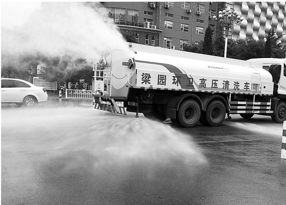
高压清洗车正在清洗道路
