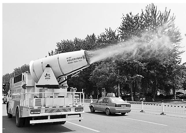
远程抑尘喷雾机正在作业
