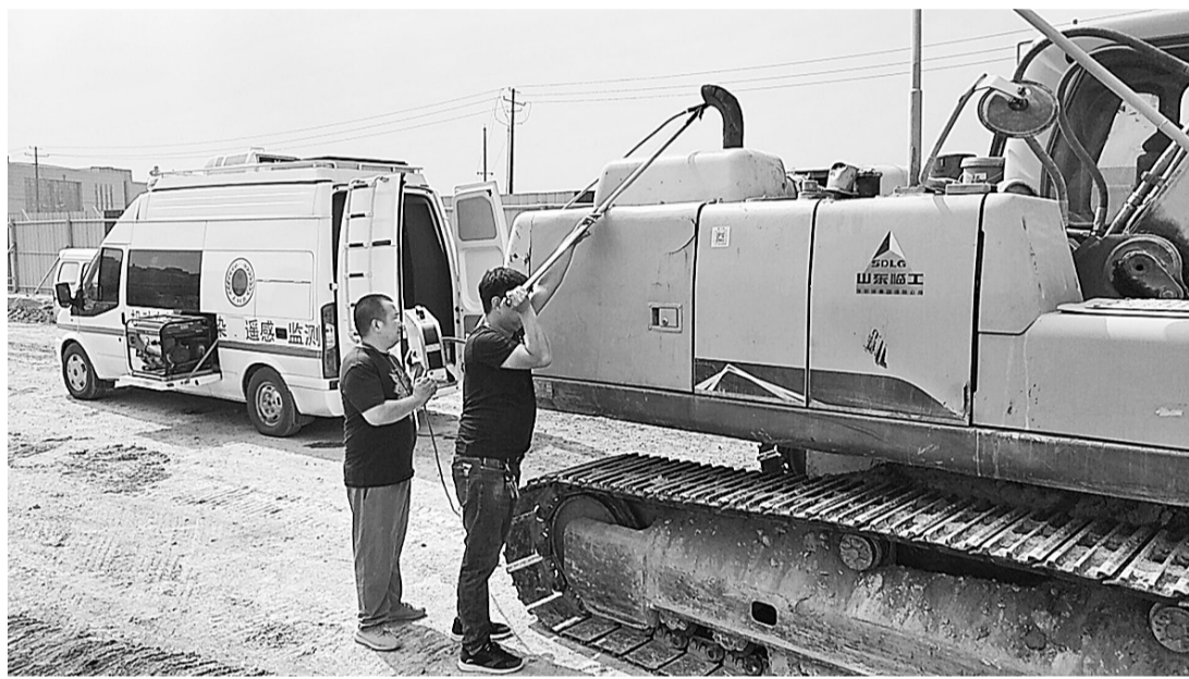
8月6日，商丘市环境监察支队环境执法人员在示范区黄河东路拓宽工程施工工地利用监测设备检测非道路移动机械尾气排放情况。 本报记者 李奇 摄
