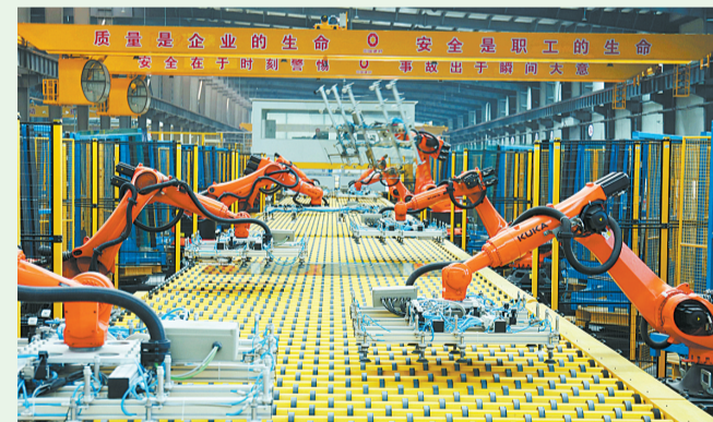
中联玻璃智能化生产车间机械手正在抓取玻璃。中联玻璃是世界五百强、央企中国建材集团凯盛科技集团下属公司，也是睢阳区的“工业一号”。本报融媒体记者 邵群峰 摄
