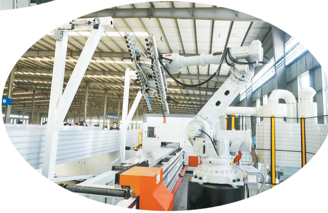
6月28日,民权县高新区宏星铝业有限公司的机器人在有序作业。据悉,该生产线应用了多项全球领先的铝板生产技术,整线集成生产人员由原来的60人减少到2人,综合能耗每平方米减少30%,产品合格率由原来的80%提高到99.92%。
