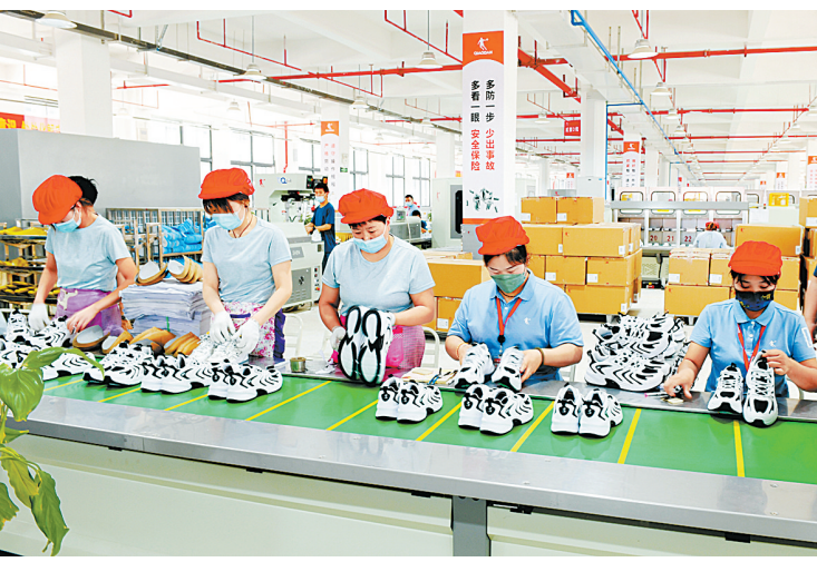
7月13日,在河南(睢县)嘉伟鞋业高频印刷车间内,工人在流水线上打印、裁剪、着色、上胶,认真制作鞋面。 本报融媒体记者 黄业波 摄
