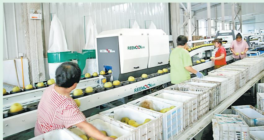
9月13日,宁陵县果蔬冷链物流产业园内繁忙依旧,不同等级的梨果被工人放到智能化自动分选设备上,经过一道道智能检测程序后,不同重量、不同糖度的梨果被分级装箱,实现智能化分拣,改变了以往人工分拣、质量不均等现象。近年来,宁陵县委、县政府持续围绕梨产业发力,不断强链、补链、延链,投资3亿元建成了集仓储、分选、物流、深加工为一体的果蔬冷链物流产业园项目,引进了NFC鲜榨果汁生产线,孵化培育了7家大型电商企业和500多名电商带头人,网上年销梨果1亿多公斤,宁陵梨品质、销量及美誉度逐年提升。
