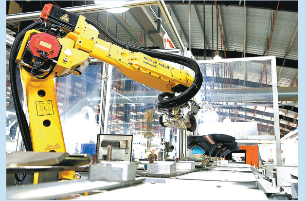
▲制鞋自动化智能化生产车间六轴机器人在作业。
