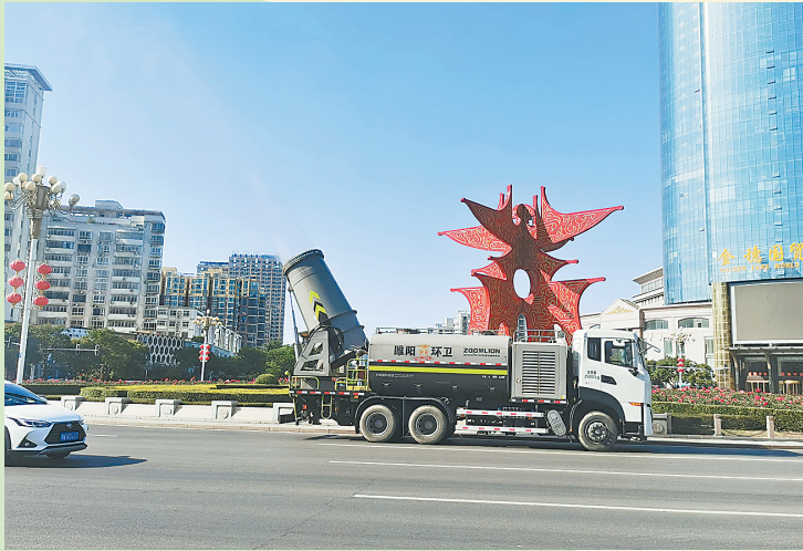
一辆“雾炮车”正在睢阳城区进行喷雾降尘作业。
