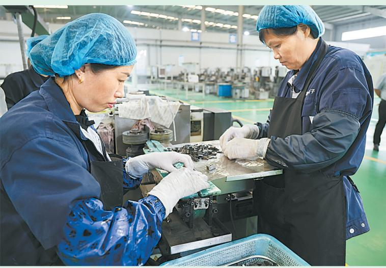
11月21日,工人在电子配件加工车间忙碌。商丘星林电子有限公司是一家研发、生产、销售稀土类永磁材料制品的高新技术企业,年可生产1亿支计算机硬盘驱动器VCM磁钢和5000万个EPS电子制动系统配件。本报融媒体记者 邢栋 摄
