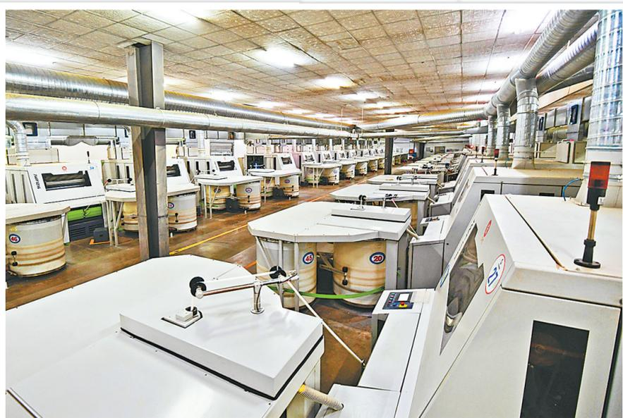
11月30日,夏邑县高新区天虹纺织有限公司无人车间机器轰鸣,一排排自动化生产线正有条不紊地运行着。该公司以“智能”促“产能”,围绕“设备换芯、生产换线、机器换人”进行智能化改造,实现了智能生产和智能管理,用工下降80%以上,成本减少30%,利税增加10%以上。 本报融媒体记者 韩丰 摄
